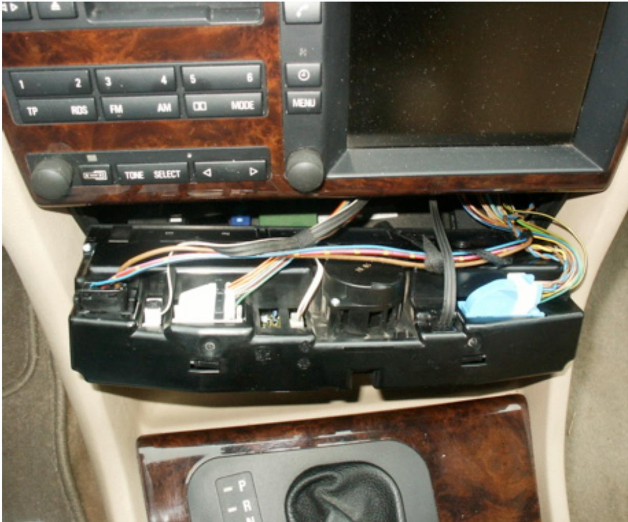
Der Stecker ganz links geht ein bisschen streng raus. Die beiden Seitenlaschen zur Entriegelung oben zusammendrücken. Unter Umständen mit einem kleine Schraubenzieher als Hebel an der Umrandung den Stecker rausdrücken. Keine Gewalt anwenden.
