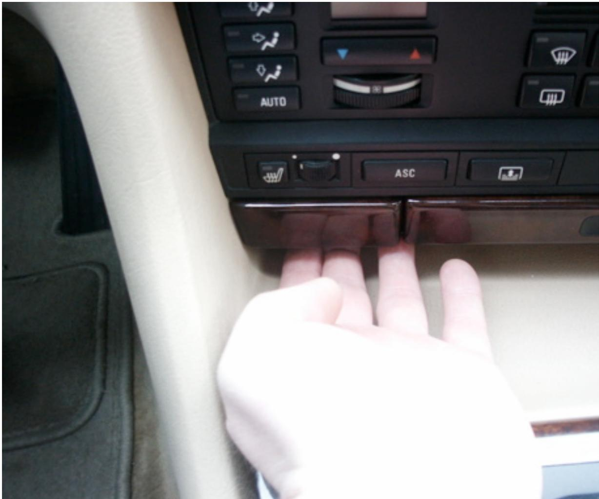
3. In das entstandene Loch greifen und den ASC Schalter (oder was auch immer an der Stelle ist) von hinten rausdrücken.
